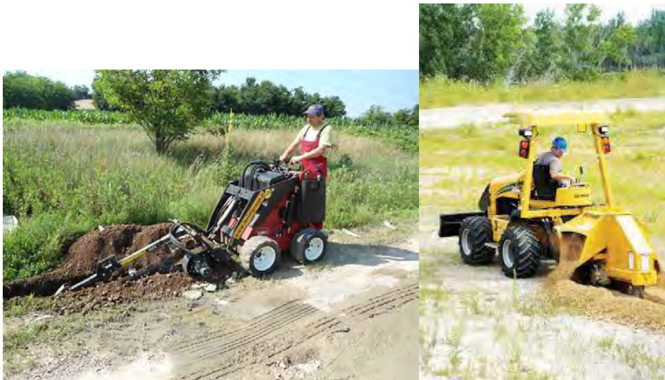
Fotografía 1.19.3. Tractor autoportante con función de zanjadora. Fuente: Vermeer.
