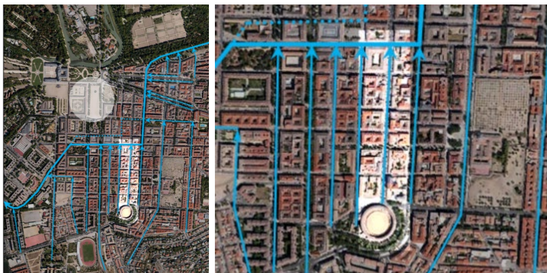
Ilustración 111. Izq.: Trazado del sistema de drenaje. Der.: Calle Almíbar y su ámbito de influencia (E.p.)
